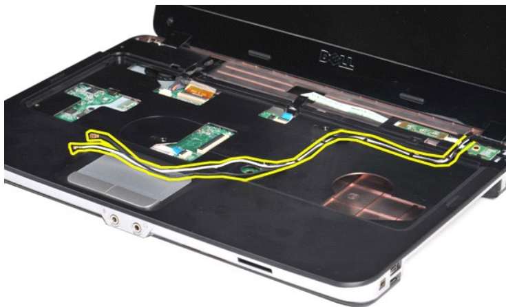
12. 旋转显示屏逆变器电缆固定夹，拔出显示屏逆变器电缆。
